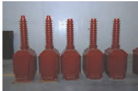
35kV Pt生产区
